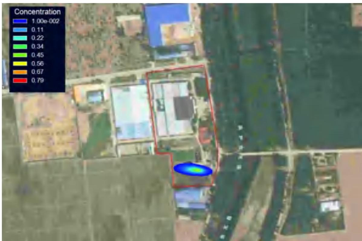
图 4.4-18 (1) CODMn 连续恒定泄露 100d 时的污染晕图
