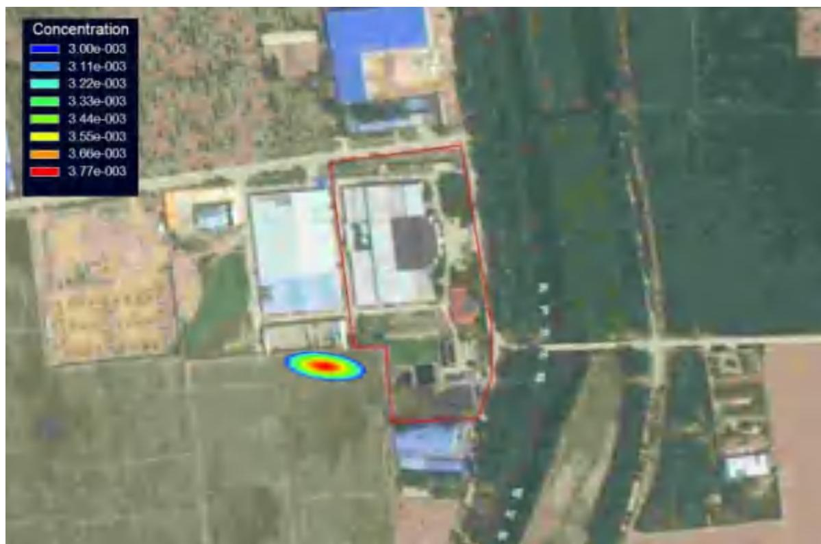
图 4.4-20 (2) 甲苯连续恒定泄露 1000d 时的污染晕图
