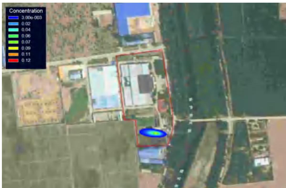
图 4.4-20 (1) 甲苯连续恒定泄露 100d 时的污染晕图
