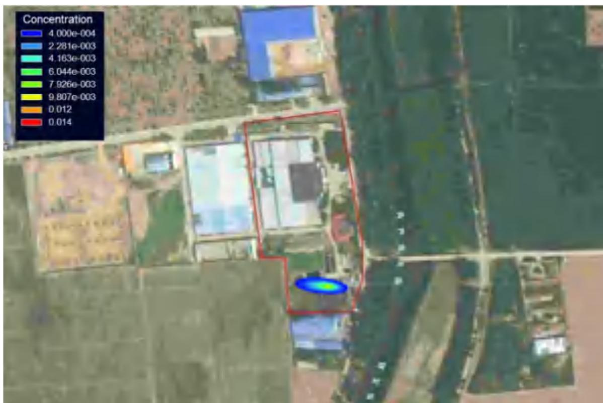
图 4.4-19 (1) 酚类（苯酚）连续恒定泄露 100d 时的污染晕图
